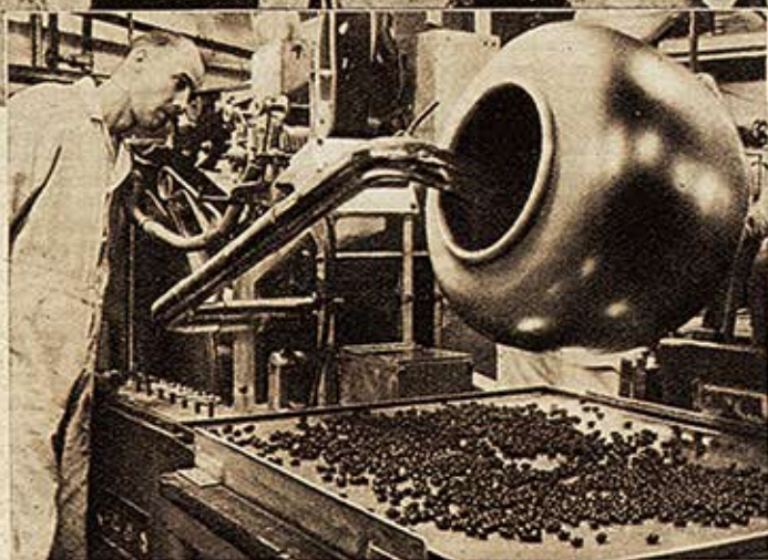
Diese Maschine stellt täglich eine Million Kapseln her. Zur Zeit arbeiten etwa zwölf solcher Spezialmaschinen auf der ganzen Welt.
